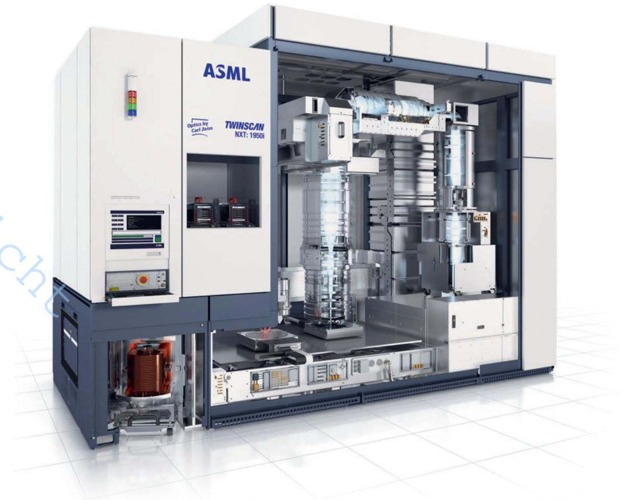
Mit der 2009 vorgestellten NXT-Plattform unterstrich ASML den eigenen Anspruch, die Waferscanner mit der höchsten Produktivität am Markt zu bauen. Die Weiterentwicklung trug auch der Tatsache Rechnung, dass die Halbleiterhersteller zur weiteren Verkleinerung der Strukturbreiten mehr Belichtungsschritte pro Chip benötigten (*multiple patterning*).
