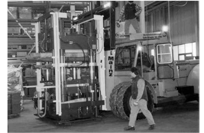
□ 1998 erhielt der Standort Damme die ersten 1 000-Tonnen-Vulkanisations-Pressen (oben). Diese wurden ab 2003 in der robotergestützten Fertigung eingesetzt.
