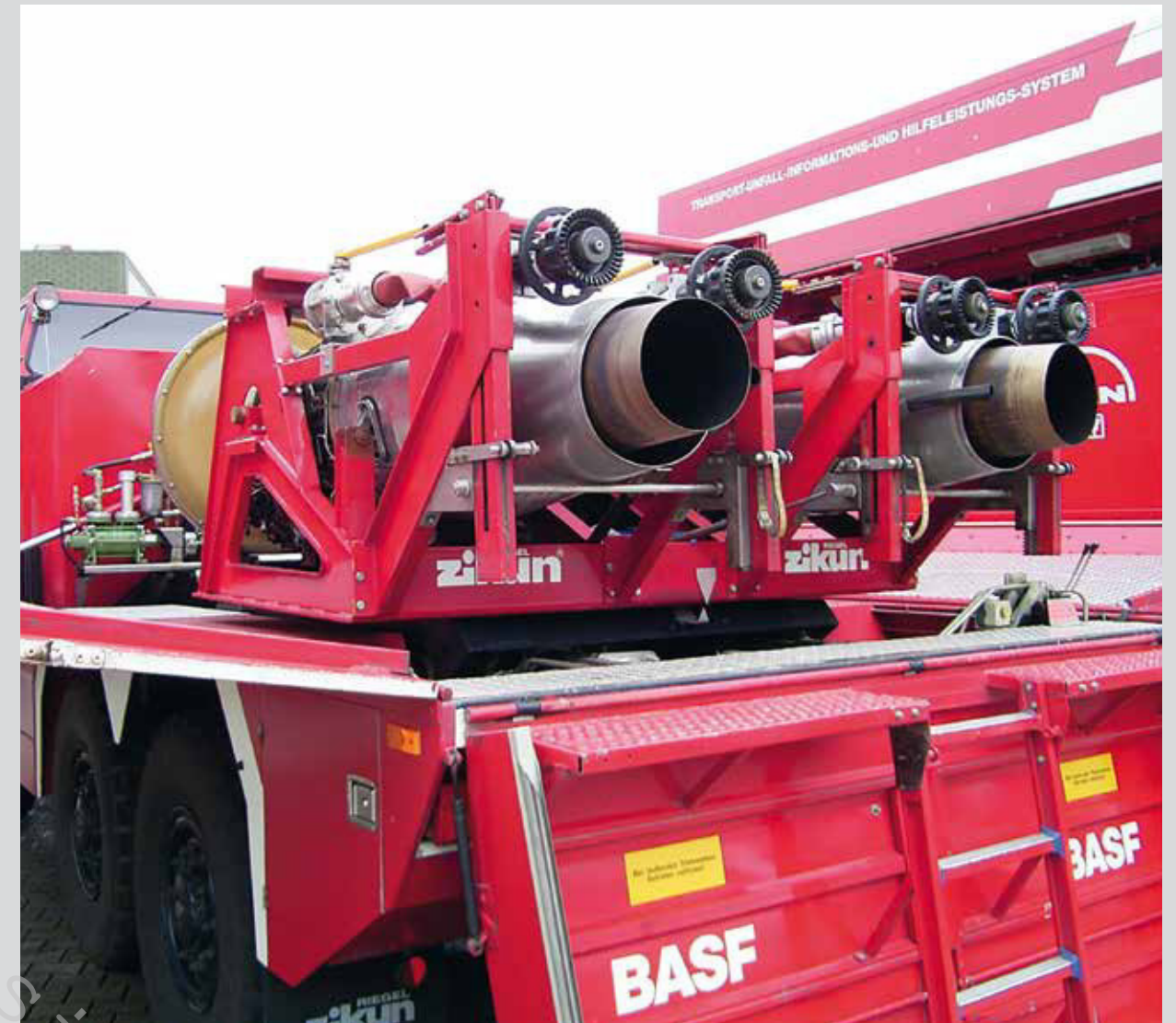
Sinnvolle Weiterverwendung: Die Larzac-Düsentriebwerke des Turbo-Löschers stammen aus Alpha Jet-Kampfflugzeugen.
