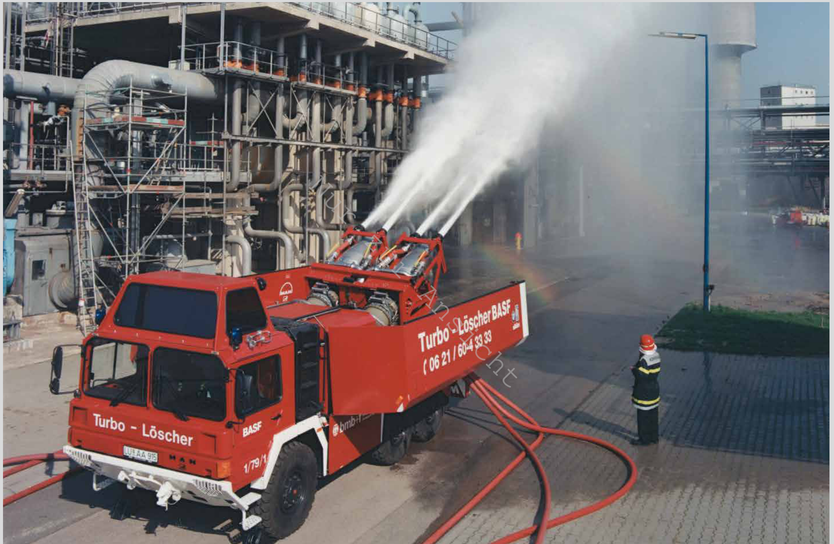
Wasser marsch: In den Abgasstrahl des Turbo-Löschers können minütlich bis zu 7000 l eingespeist werden.
