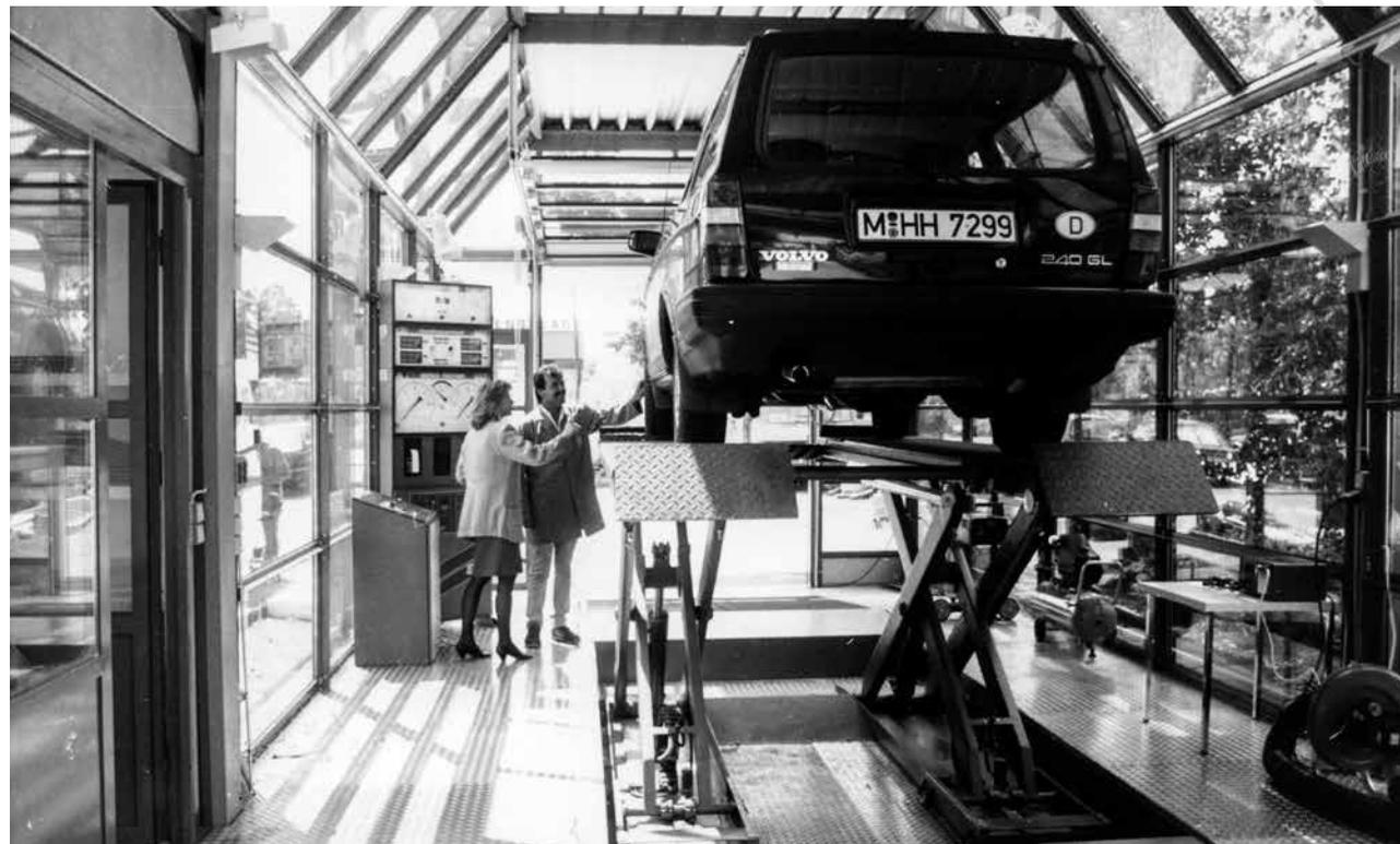
Gruben oder Hebebühnen erleichtern die Untersuchung von Unterboden und Rädern.
