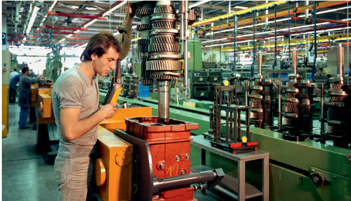
Die Ecosplit-Baureihe war kommerziell langfristig erfolgreich. Bis 2015 wurden über 2,8 Millionen Einheiten gefertigt. Im Bild die Montage eines Ecosplit-Getriebes in Friedrichshafen (Halle 9), 1981.
